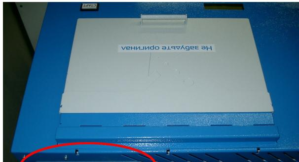
Перед тем как поднять столешницу, **нужно открутить 3 винта**, как показано на картинке (два винта откручиваются через платежный отсек, один – через рабочий отсек).
